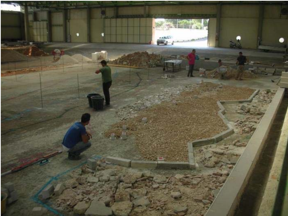
Fig. 2.8: fase costruzione del modello: realizzazione parte emersa.
