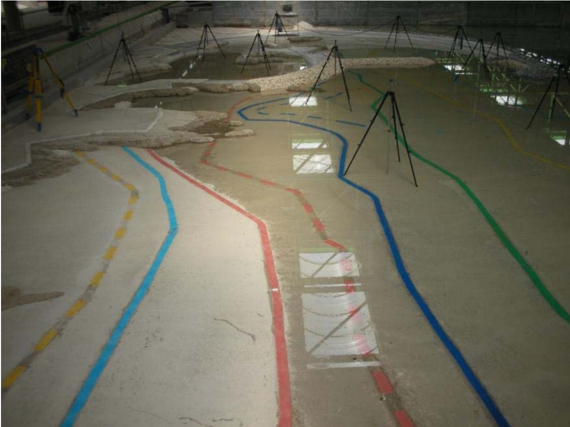
Fig. 2.42: fase di riempimento della vasca: è possibile constatare la correttezza della batimetria del fondale realizzato.
