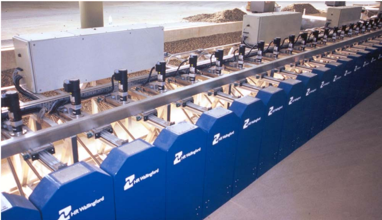
Fig. 4.1.1: generatore di moto ondoso per modelli 3D.
