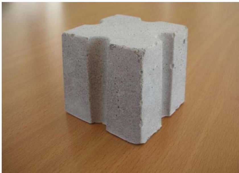
Fig. 2.38: modello fisico del masso “Antifer” realizzato.
