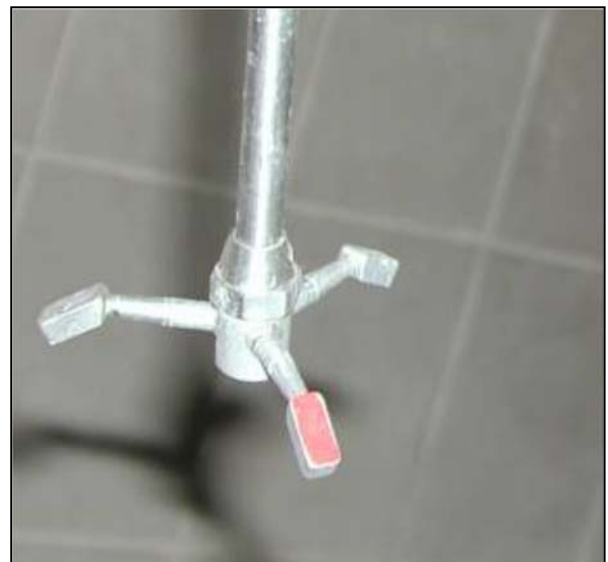
Fig. 4.3.1: particolare della sonda ADV di tipo 2D- side looking . Fig. 4.3.2: particolare della sonda ADV di tipo 3D- down looking .
