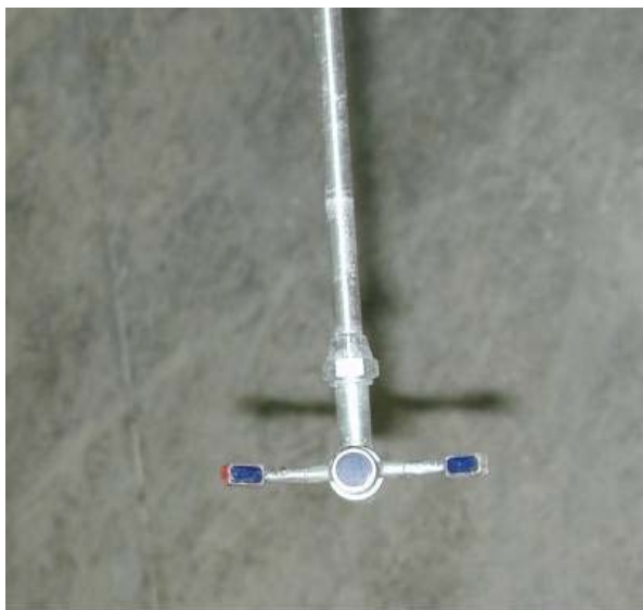
Fig. 4.3.1: particolare della sonda ADV di tipo 2D- side looking . Fig. 4.3.2: particolare della sonda ADV di tipo 3D- down looking .
