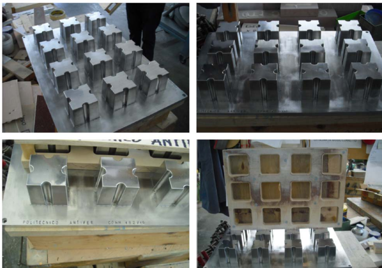
Fig. 2.39: fase di realizzazione degli stampi per i modelli “Antifer”.
